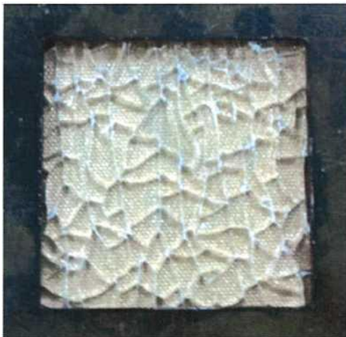
图 39: 36#样品碎片状态 Fig. 39: Fragmentation of the sample 36#
