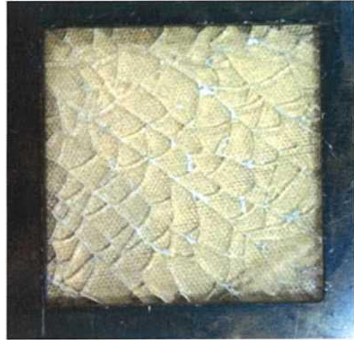
图 38: 35#样品碎片状态 Fig. 38: Fragmentation of the sample 35#
