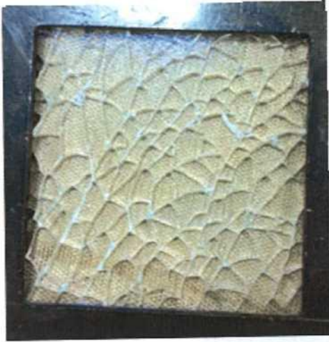
图 37: 34#样品碎片状态 Fig. 37: Fragmentation of the sample 34#
